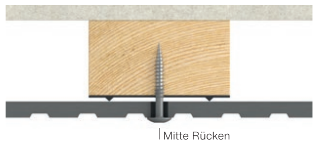
Abb 2. Montage Swisspearl Patina Inline in der Tafelfläche
